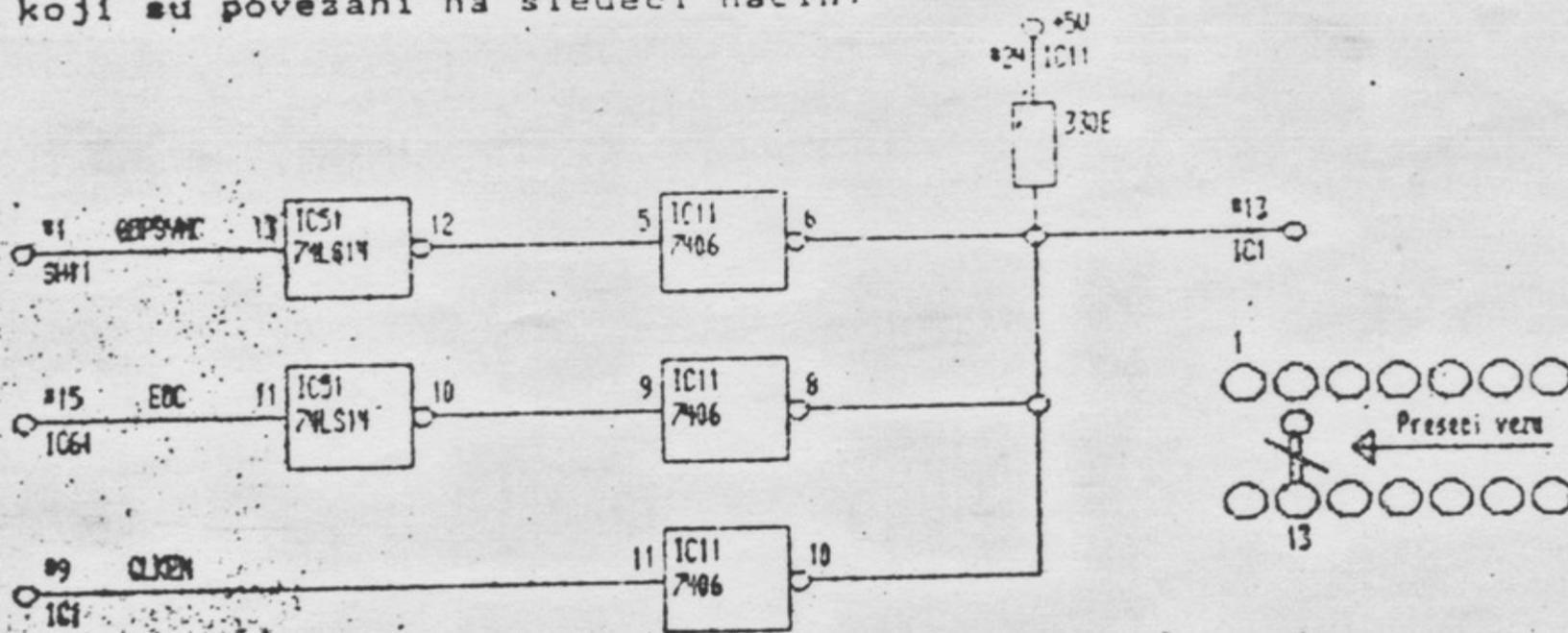
Signal CLKEN je iskorišćen da se obezbedi reset ~~na~~ na prvom EOC impulsu nakon pojave AHSYNC.
