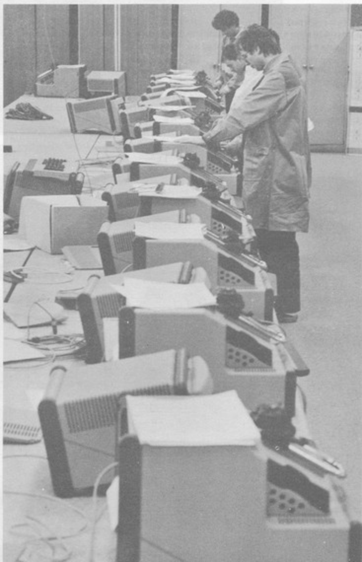
Slika 6 (desno). Namizna izvedba mikroračunalniških sistemov Triglav je namenjena njihovi uporabi s funkcijo visoko zmogljivih delovnih postaj za različne namene (CAD/CAM, grafika za različne uporabne naloge, komunikacijske mreže itd.). Sistemi Triglav uporabljajo lastne, tj. domače module s tremi različnimi mikroprocesorji na vodilu VME. To vodilo je industrijski standard. Tudi operacijski sistemi za računalnike družine Triglava so različni in omogočajo uporabo najširšega spektra uporabniških programov. Ti operacijski sistemi so Delta-M, Xenix, Unix in MS-DOS.
