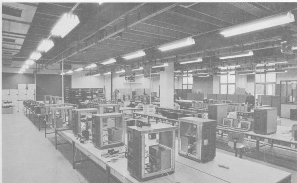
Slika 5 (zgoraj). Na sliki je prikazana proizvodnja mikroračunalniških sistemov Triglav (stolpna ali obmizna izvedba) s 16-bitnimi procesorji J11, M68010 in I80286. Te konfiguracije je mogoče raznovrstno dopolnjevati z disketnimi, diskovnimi in tračnimi enotami.
